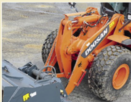
Die Schwinde hat eine Z-Kinematik und hebt knapp 13 t. Die Werkzeugaufnahme entspricht den landläufig als „Volvo-System“ bezeichneten Maßen.
