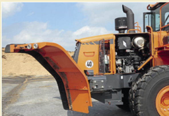
Das Knickgelenk ist sehr aufgeräumt, die Leitungsführung vorbildlich. Eine SKF-Zentralschmieranlage versorgt alle Drehpunkte mit Fett.
