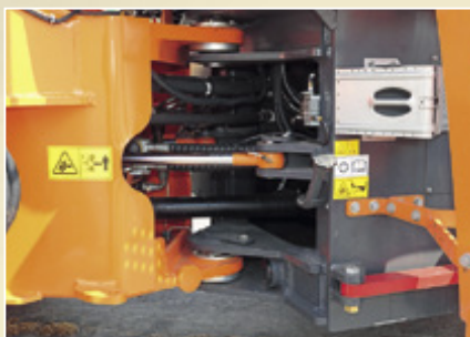
Das Knickgelenk ist sehr aufgeräumt, die Leitungsführung vorbildlich. Eine SKF-Zentralschmieranlage versorgt alle Drehpunkte mit Fett.
